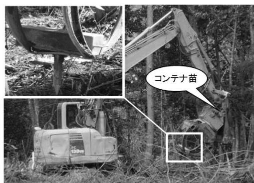
写真2. 機械植付用穴開け器 （左上は白枠内を拡大したもの）
