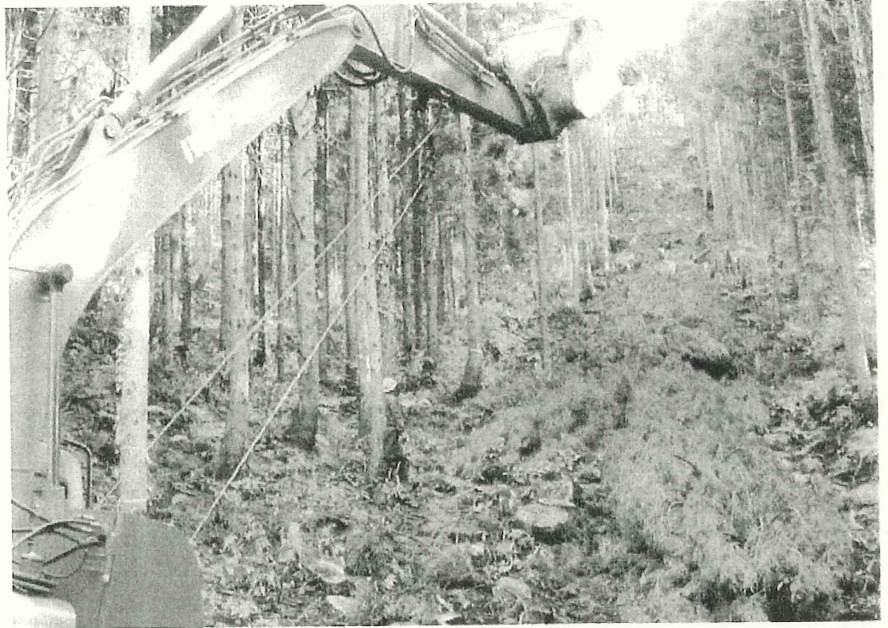
スイングヤーダによる列状間伐集材作業
