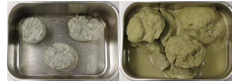
写真 3.1 凝灰岩試料の浸水崩壊度試験状況（左：初期状態、右：浸水 24 時間後）
