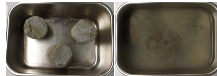
写真 3.2 泥岩試料の浸水崩壊度試験状況（左：初期状態、右：浸水 24 時間後）
