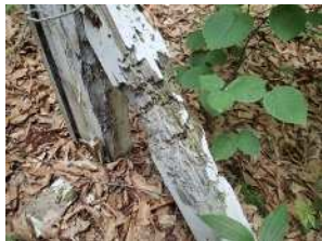
支え木の腐朽(秋 B-1)
