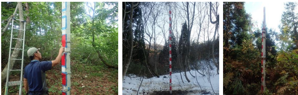
写真6 インターバル撮影のための積雪深計の着色状況(左: B-7の着色、中: B-7完成、右: 秋B-4完成)
