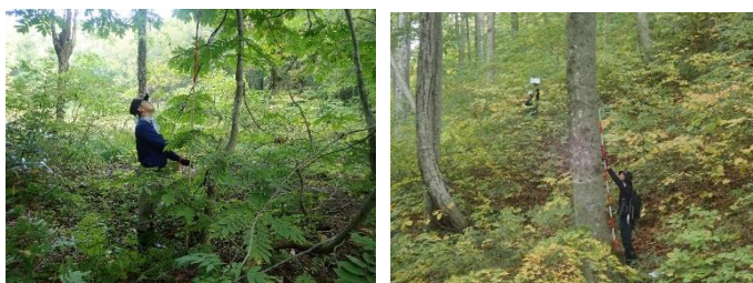
写真12 樹高計測状況(左:測棒、右:バーテックス)
