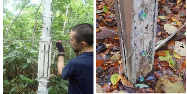
写真5 針金の追加(B-4)とロガーの設置状況(B-10)
