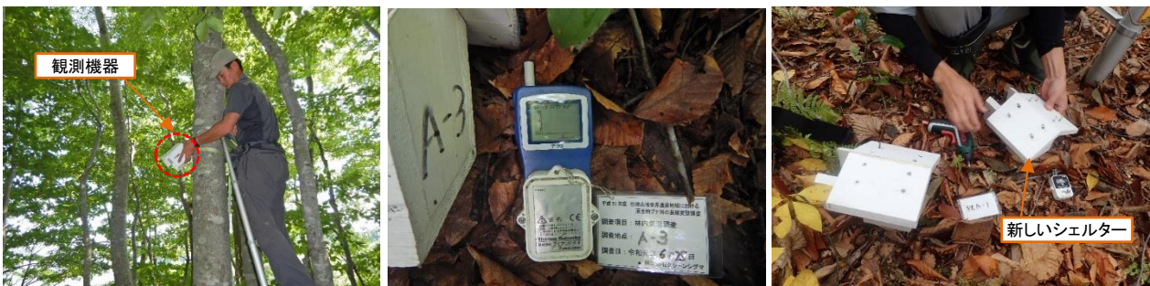
写真6 林内気温調査状況 (左:設置状況(秋A-3)、中:データの読み取り(A-3)、右:シェルター交換(秋A-1))
