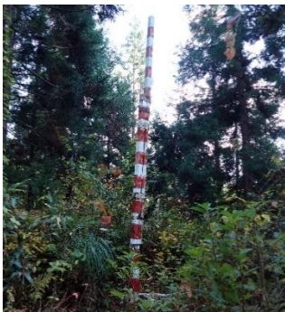
写真 1 インターバル撮影による最深積雪深の計測 (左: 最深積雪深計、右: 自動撮影カメラの設置状況)
