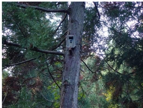
写真 1 インターバル撮影による最深積雪深の計測 (左: 最深積雪深計、右: 自動撮影カメラの設置状況)
