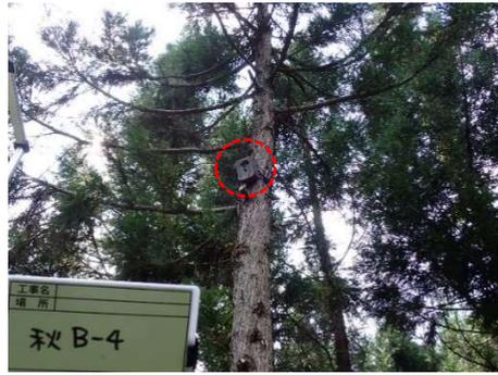
写真1 インターバル撮影による最深積雪深の計測
