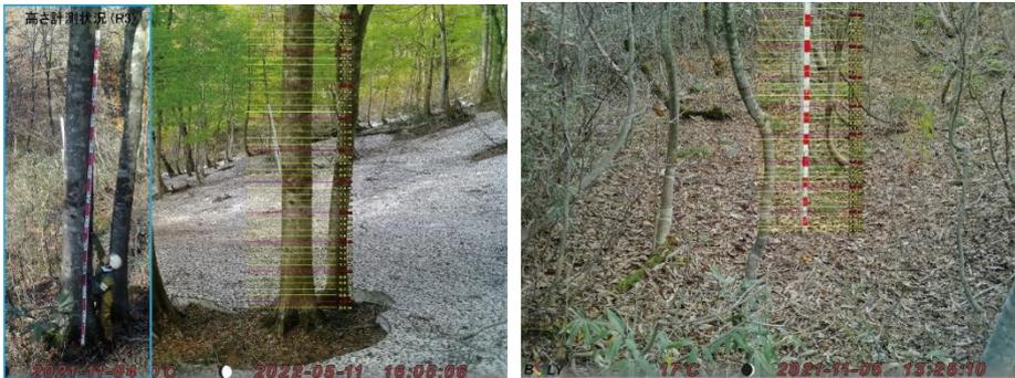
写真4 インターバル撮影による積雪深の計測指標
