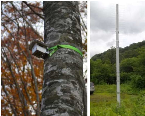
写真1 観測の様子 (左: 林内気温、右: 最深積雪深計)[6]
