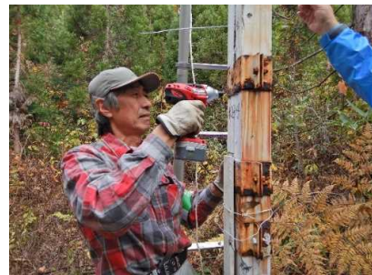
写真1 最深積雪深計の針金追加（秋B-4）
