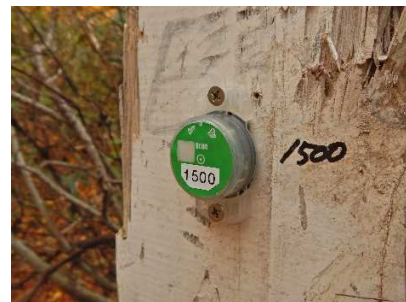
写真2 機材を更新した積雪深調査用の 温度計測データロガー（B-10）
