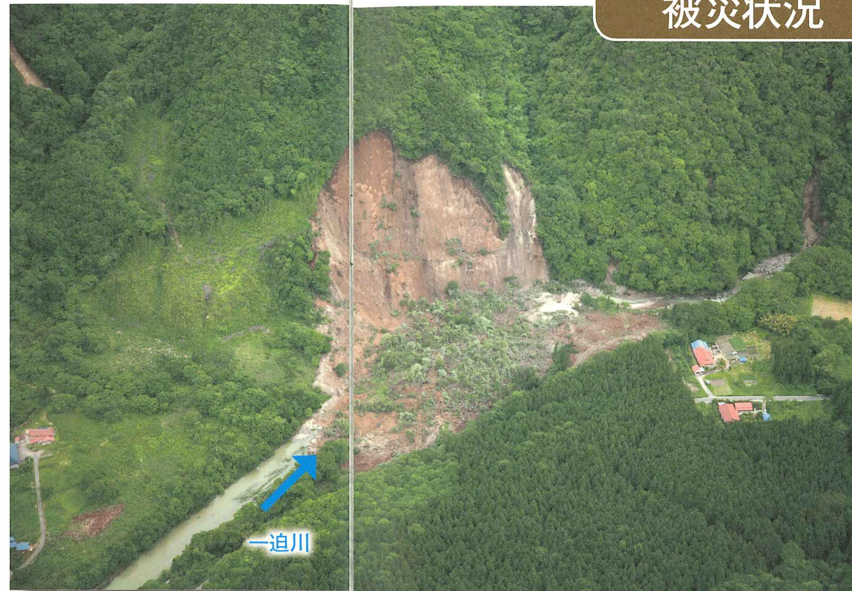
1 浅布区域 山腹崩壊により寸断された国道と河道閉塞状況
