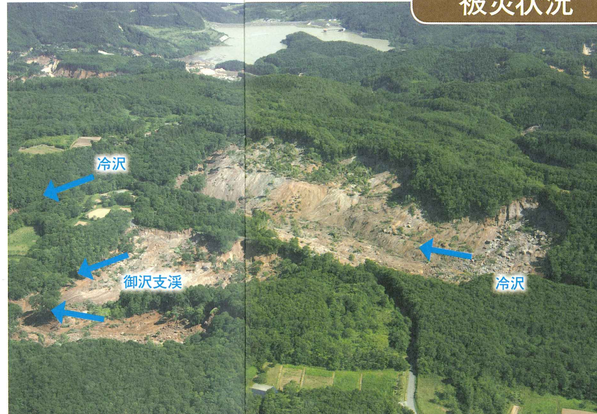
1 冷沢・御沢周辺 山腹崩壊と溪流荒廃の状況 (奥は荒砥沢ダム) 冷沢・御沢で発生した山腹崩壊の崩落土砂は極めて流動性が高いため、不安定土砂の多くが土石流となって御沢下流域へ流出
