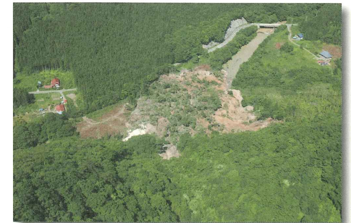
2 浅布区域 寸断された国道と河道閉塞状況(崩壊地上空より) 崩れ落ちた土砂は民家近くに迫る
