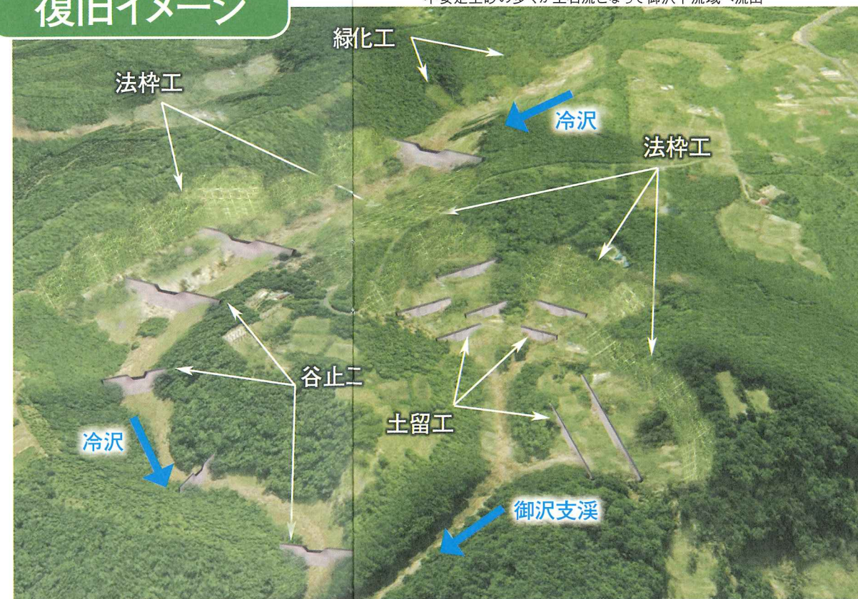
1 冷沢・御沢周辺 山腹崩壊と溪流荒廃の状況 (奥は荒砥沢ダム) 冷沢・御沢で発生した山腹崩壊の崩落土砂は極めて流動性が高いため、不安定土砂の多くが土石流となって御沢下流域へ流出
