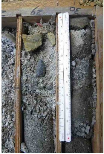
<BV-4(27.4m)> 礫混り土底面で混入する円礫
