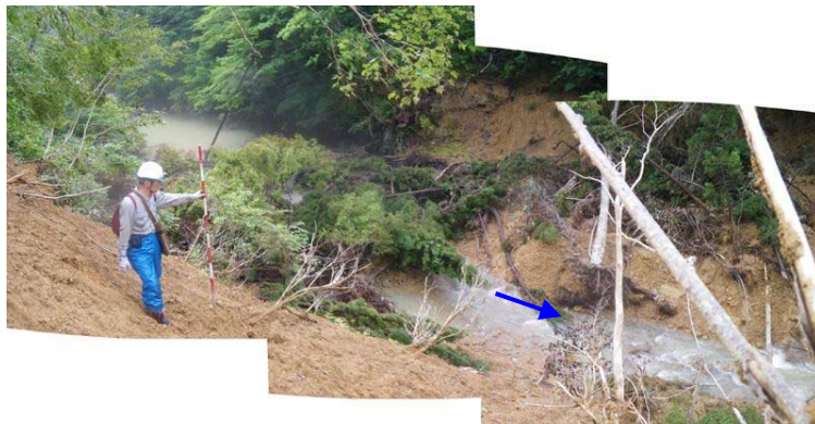
①タモノキ沢最下流湛水池(崩壊土砂による湛水池)
