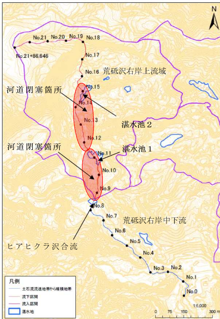
図 4.2.1 荒砥沢右岸流路における河道閉塞と湛水池の分布状況
