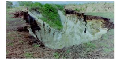
15 滑溜帯延長上に発生した崩壊 (シラス)
