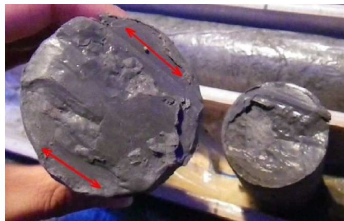
写真 3.1 すべり面コア (CB-1 : GL-103.7m)
