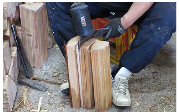
(写真3) 年輪に沿って割る作業「小割」
