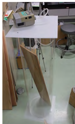
アクリルパイプに入れた スギ心材から香り成分を採取 しているところ
