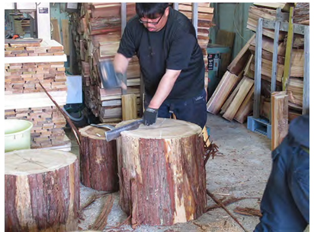
(写真2) 秋田杉の丸太を割る作業「大割」
