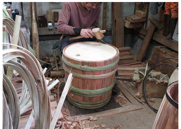
(写真4) 蓋をして微調整「仕上げ」
