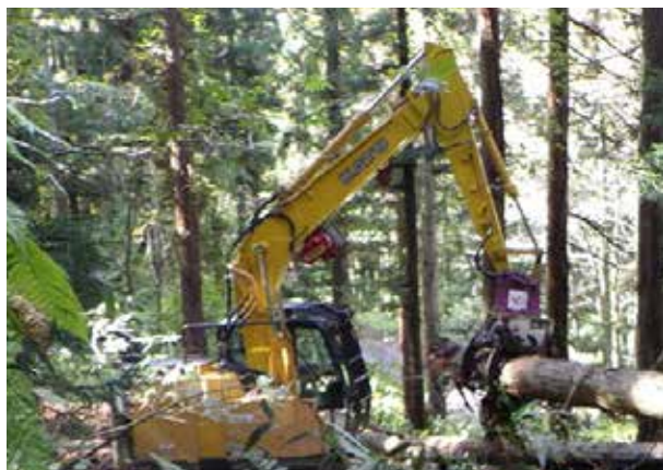
林業機械(ザウルスロボ)による搬出路作設
