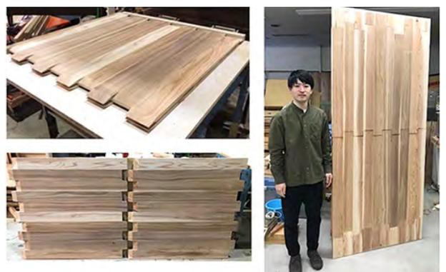
凹凸CLTとその接合様態
