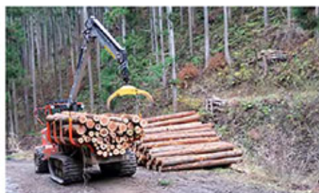
写真1 高性能林業機械を用いた素材生産 (登米市津山地区)
