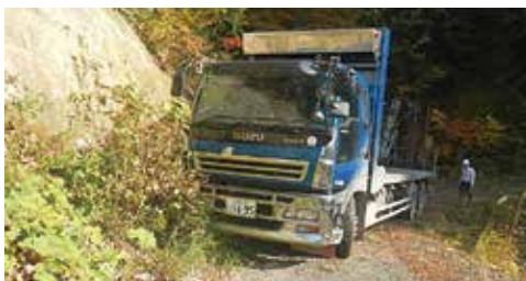
R=12 外側では草木や崩土が支障となる
