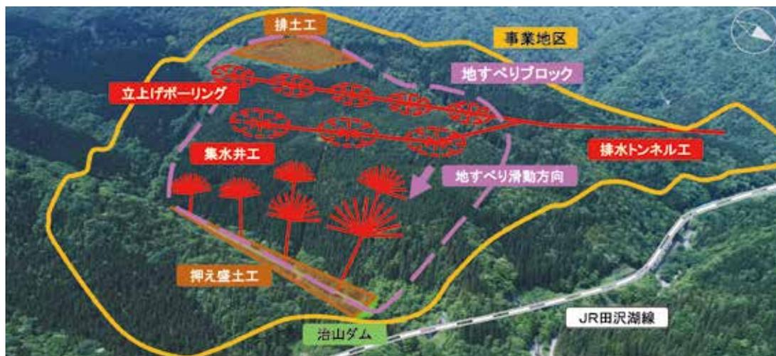
図④ 地すべりブロックと想定される対策工の概要
