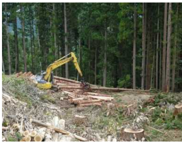
一貫作業システム（伐採 → 丸太運搬 → コンテナ苗運搬） （写真左）高性能林業機械による造材の様子 （写真右）コンテナ苗運搬の様子
