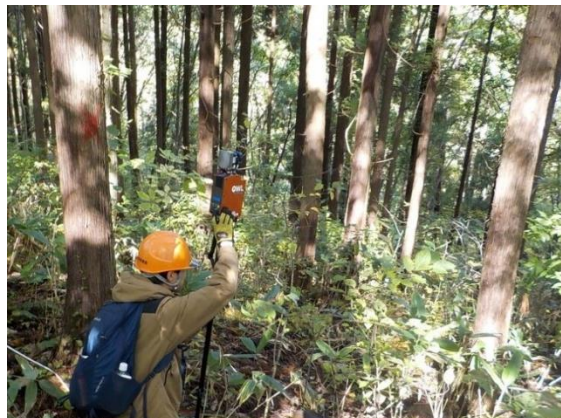
地上型レーザースカナ (OWL) による収穫調査 (馬淵川上流森林計画区)
