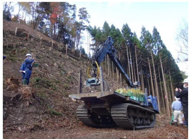
一貫作業システム フォワーダによる苗木運搬 (宮城北部森林計画区)
