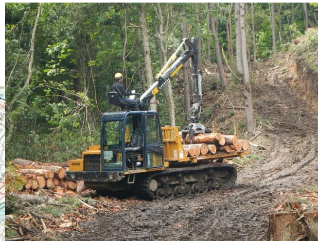
森林作業道で事業実行中の高性能林業機械 （グラップル付きフォワーダ） （七戸町）
