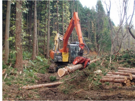
高性能林業機械(プロセッサ) (むつ市川内町)
