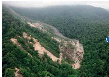
北沢最上流部 山腹崩壊により発生した不安定土砂の堆積状況
