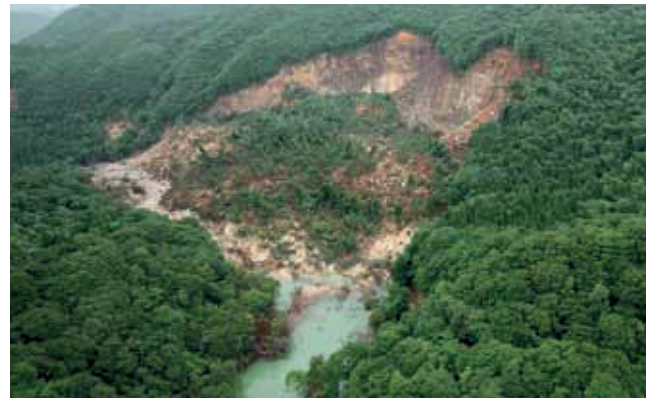
御沢下流域 日影森地すべりによる河道閉塞状況
