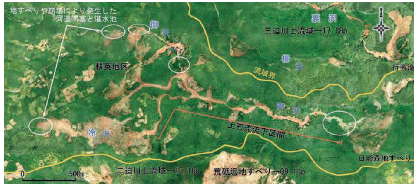
耕英地区全景 山腹および溪流荒廃状況のオルソ画像（朝日航洋株式会社撮影） 御沢・冷沢で発生した山腹崩壊により流動性の高い崩積土が土石流となって御沢下流域へ流出
