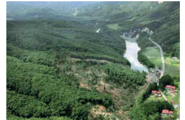
磐井川 地すべり末端部の河道閉塞状況
