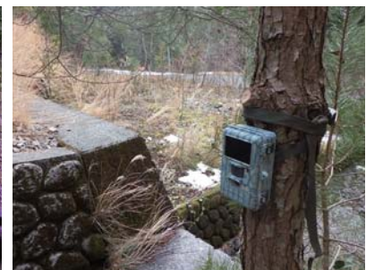
センサーカメラで水路を監視
