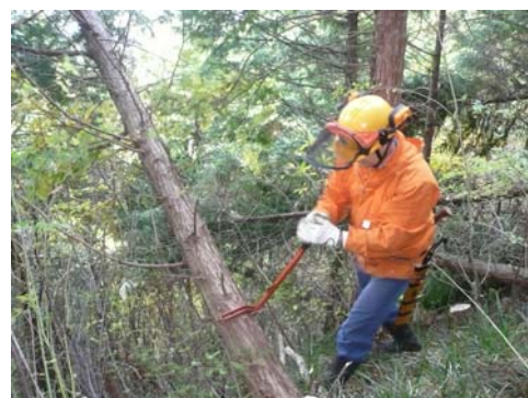
写真7 フェリングレバー使用状況
