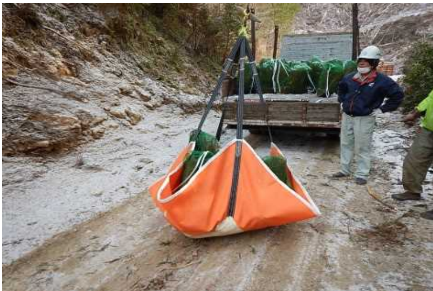
架線による苗木運搬
