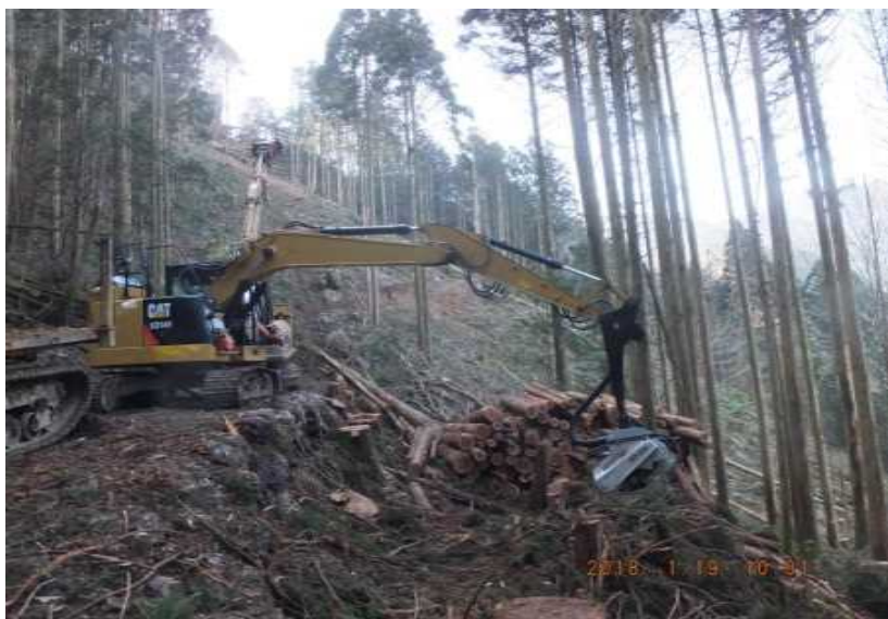
プロセッサによる枝条整理
