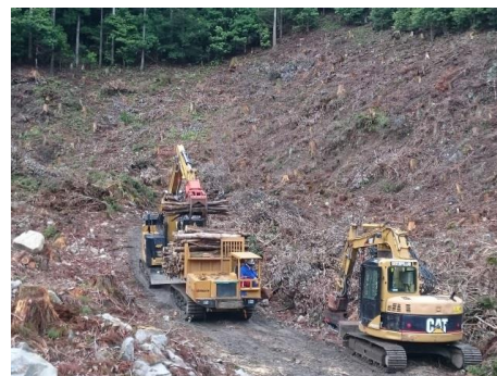
フォワーダーによる低質材運搬状況
