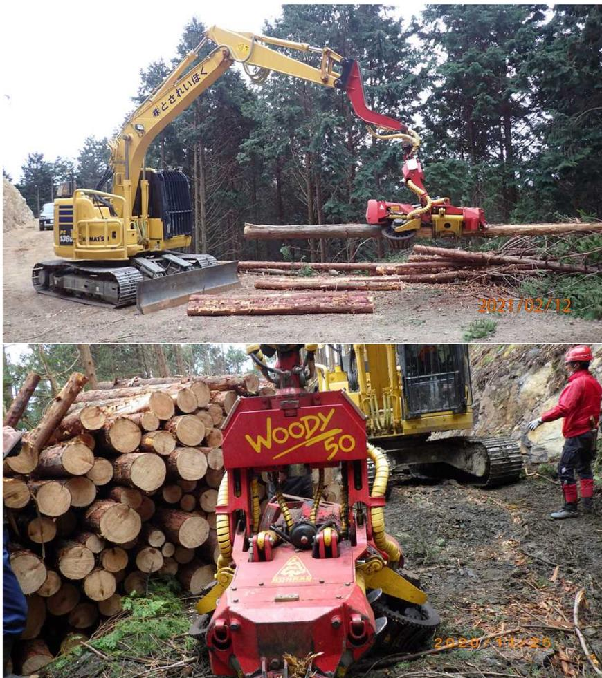
Woody50は、元口径と末口径の平均値をその丸太の径級とし、この径級から算出した断面積に材長を乗じて一玉毎、そして全材の材積を求める断面積計算法を採用する。
