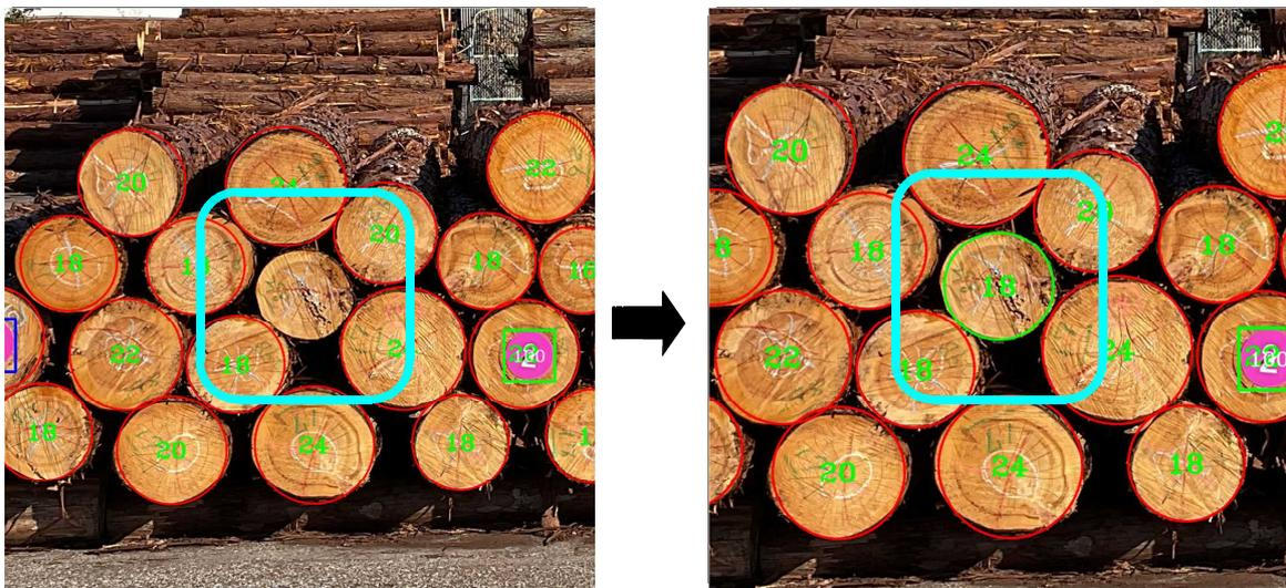
※補正する例3:直径の過小・過大検出の修正
