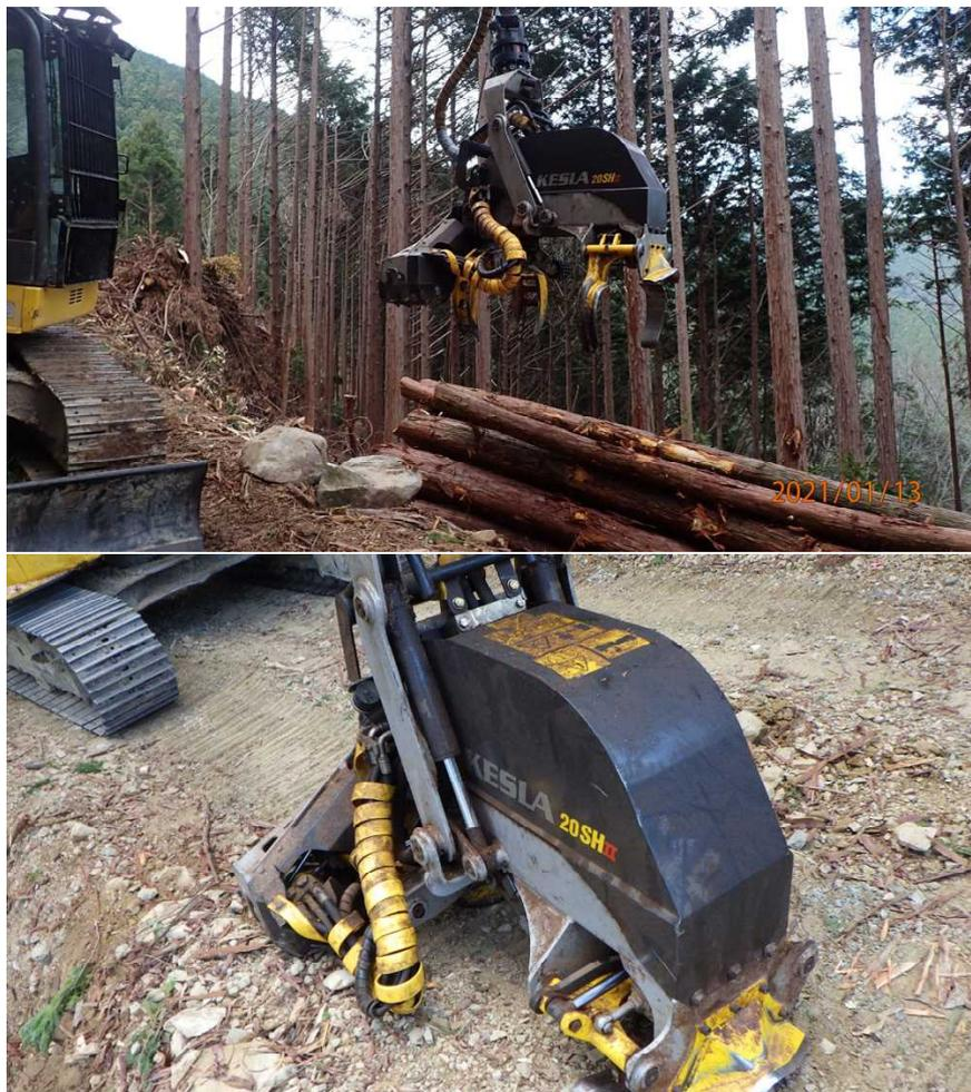
KESLA20SHは、丸太中央の直径を計測し、算出した断面積に丸太の材長を乗じて一玉毎、そして全体の材積を求める断面積計算法を採用する。
