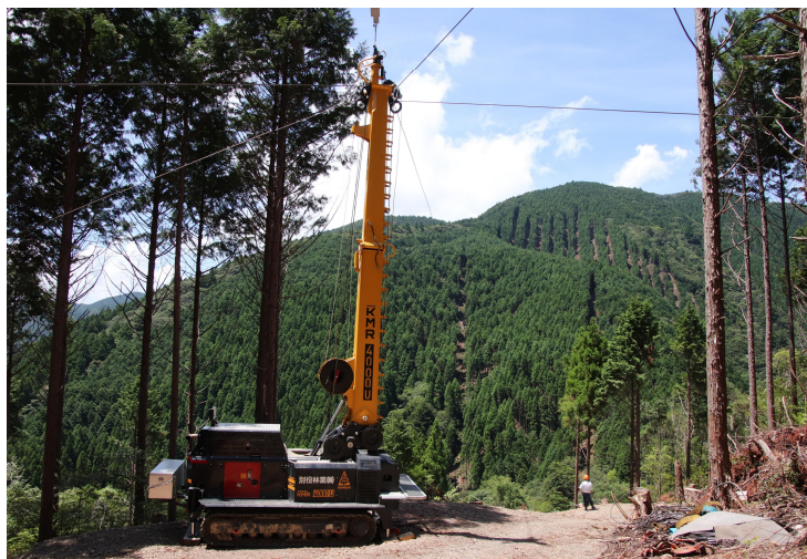
生産事業請負箇所でのタワーヤーダによる架線集材
