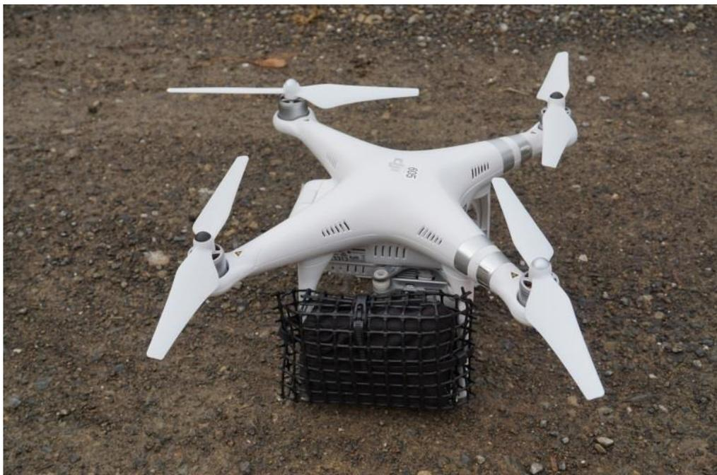
中継機を搭載したドローン
