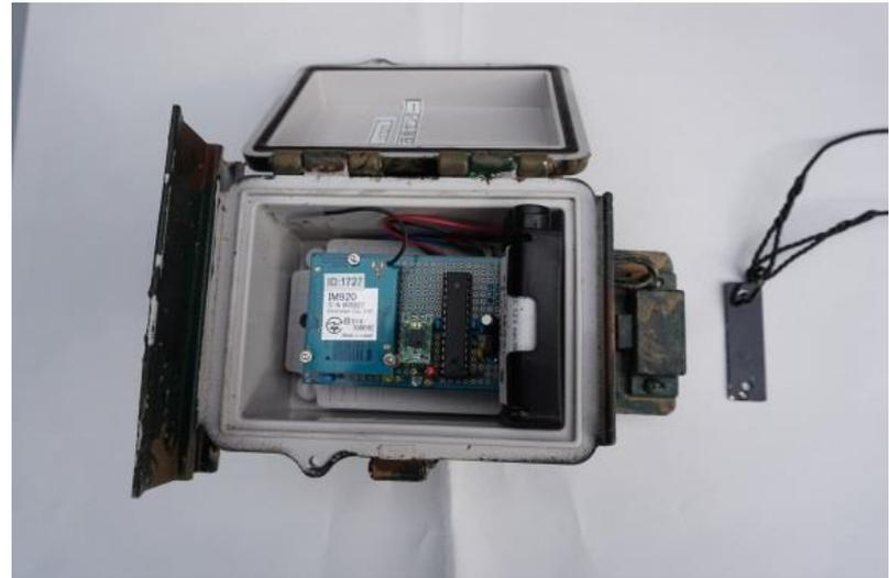
右のロープを引くとマグネット式の板が本体から外れ、「捕獲」を知らせる電波が発信される(電波自体は10秒毎に24時間発信。電池の寿命は約1箇月)
