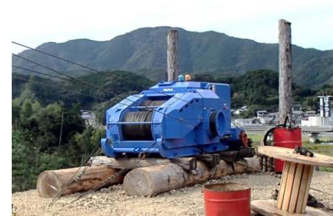
油圧集材機 (無線により遠隔操作)
