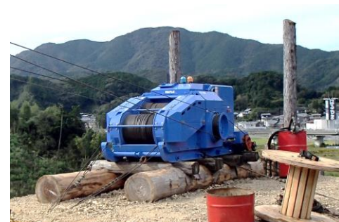
油圧集材機 (無線により遠隔操作)
