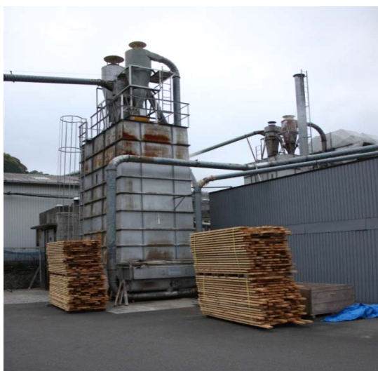
木材乾燥のための熱を供給する 木質バイオマスボイラー (高知県四万十町)
