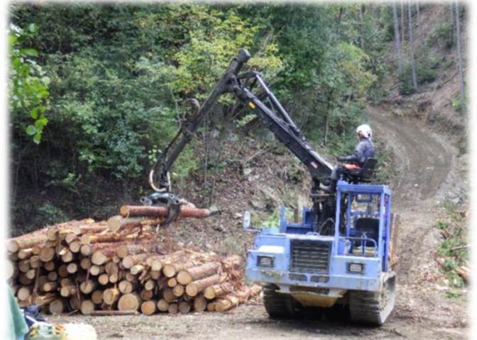
整備した路網による搬出作業
