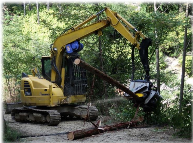
プロセッサによる造材作業
