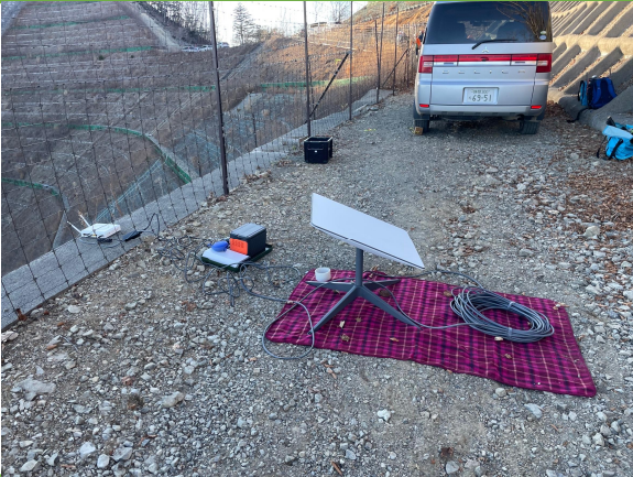
衛星通信アンテナの展開状況
