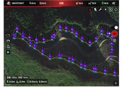
自動飛行経路の順番としては、まず「(株)ジツタ」が開発したソフト「3d Flight Planner」と「QGIS」を使用し、決められた高度で、防護柵から一定の距離を保った状態での飛行経路を作成します。そのあと、その飛行経路を「Litchi」(ドローン飛行ソフト)に取込み自動で飛行を行います。一度、飛行経路を設定すれば、その後は、同じ経路での飛行が可能であることから、巡視が手軽に行うことができ、おのずとその頻度が高まることで、防護効果の維持が期待できます。
