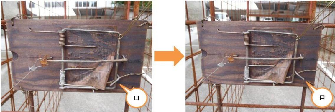
(15) わな作動確認の為、わな内のワイヤーBにふれてみて、ゲートが作動すればOKです！
