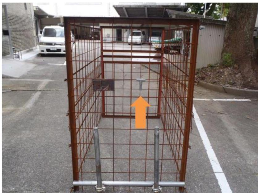
(3) ねずみ取りを写真のようにセットしJ字型鉄棒の曲部とねずみ取りのバネ部をしっかりとした真鍮針金で結ぶ。
