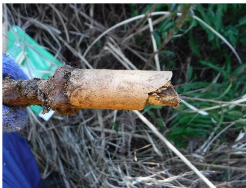
セラミックの分解が進んでいない。根元が瘤状になっている
