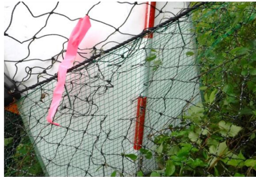
タイプB 本体ネットの破損
