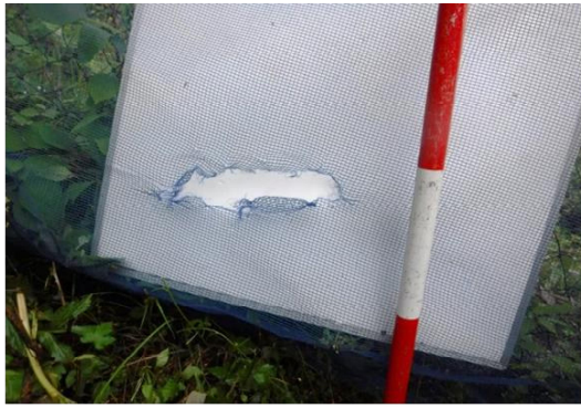
タイプA 防風用ネットの破損
