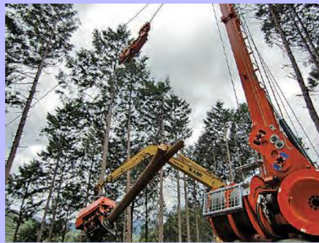
欧州のタワーヤーダを利用した間伐作業
