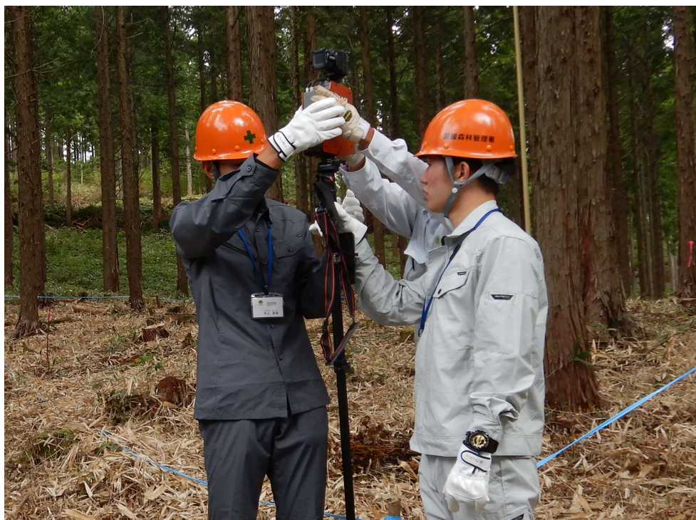
森林3次元計測システムOWLによる森林蓄積の把握実習(令和4年度愛媛大学インターンシップ)
