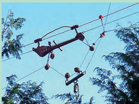
コレクター集材に用いる搬器 (ホイースチングキャレージを使用した例)
