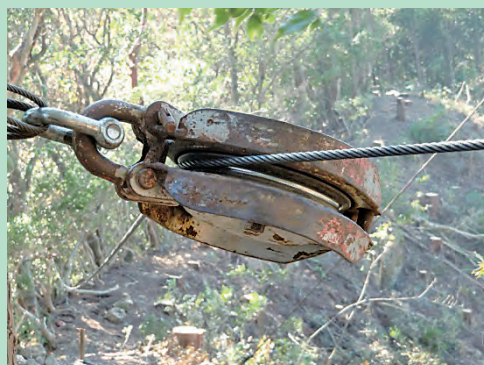
側板を補強したガイドブロック
