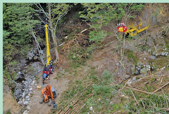
タワーヤードを用いた索張り方式
