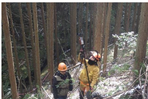
地上型3Dレーザースキャナによる 森林資源量調査
