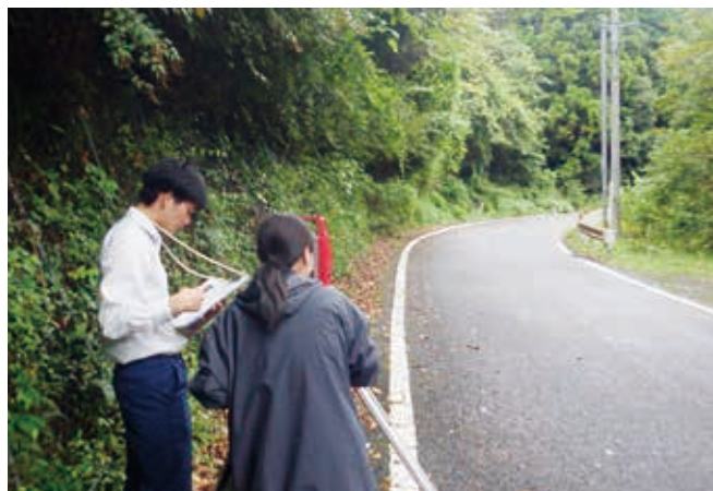
測量機器（トータルステーション）を使用した境界標の検測
