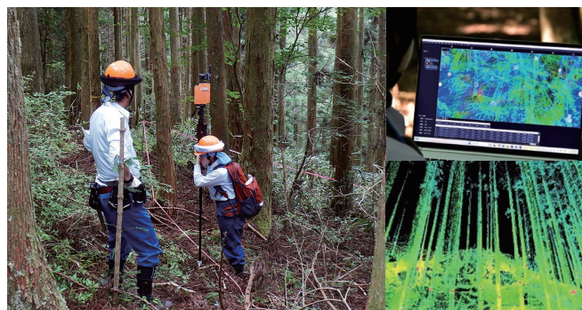
地上型3Dレーザスキャナによる森林資源量調査
